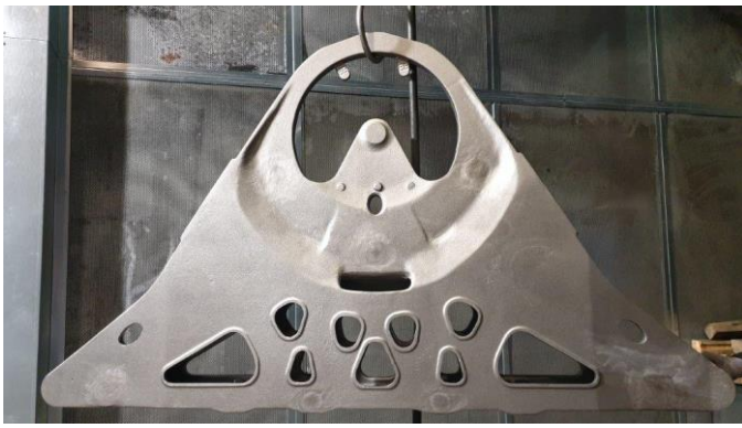
Bild 2 / Fahrzeugteil-Gelenk, 356 kg, EN-GJS-540-9, Eisengießerei Baumgarte GmbH in Bielefeld
